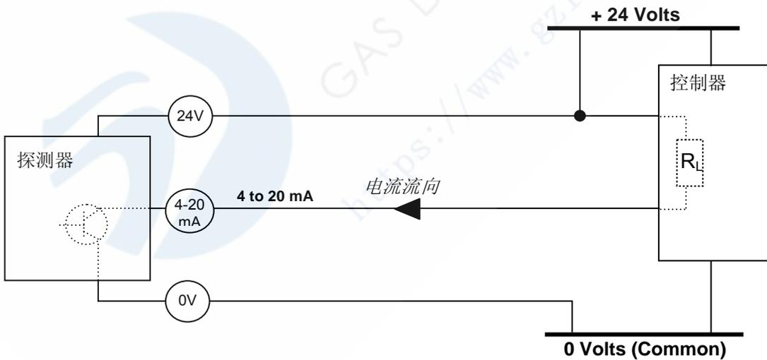
图8：漏电流接线法
