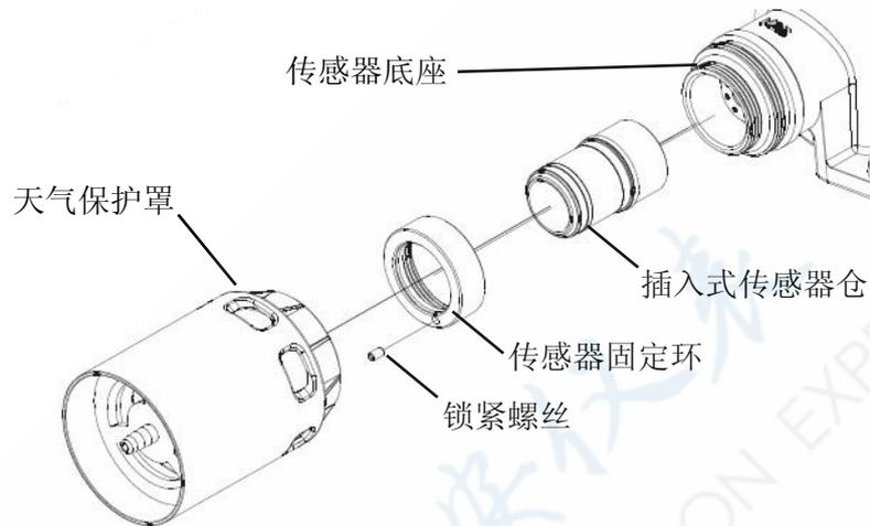
图 6：安装传感器
