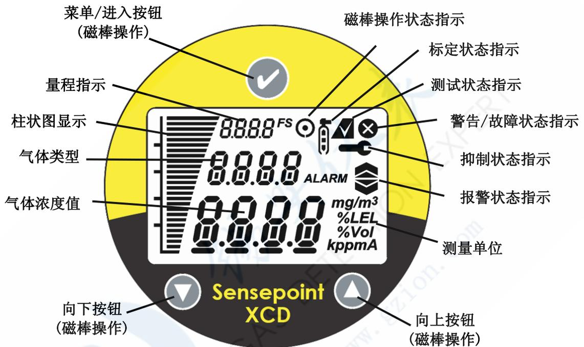
图 2: Sensepoint XCD 显示和磁棒操作示意图
