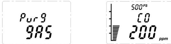
19. 关闭标定气体，拆下 Sensepoint XCD 标定帽，让气体消散。
