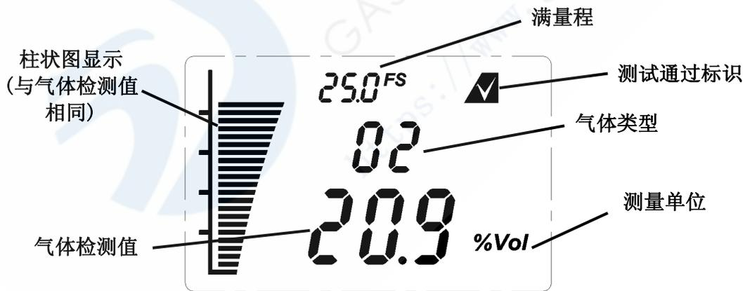
图 10: O<sub>2</sub>探测器 LCD 显示-正常状态
