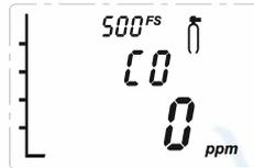
6. 当零点标定完成后，用磁棒点下'✓'键，确认零点标定完成。
